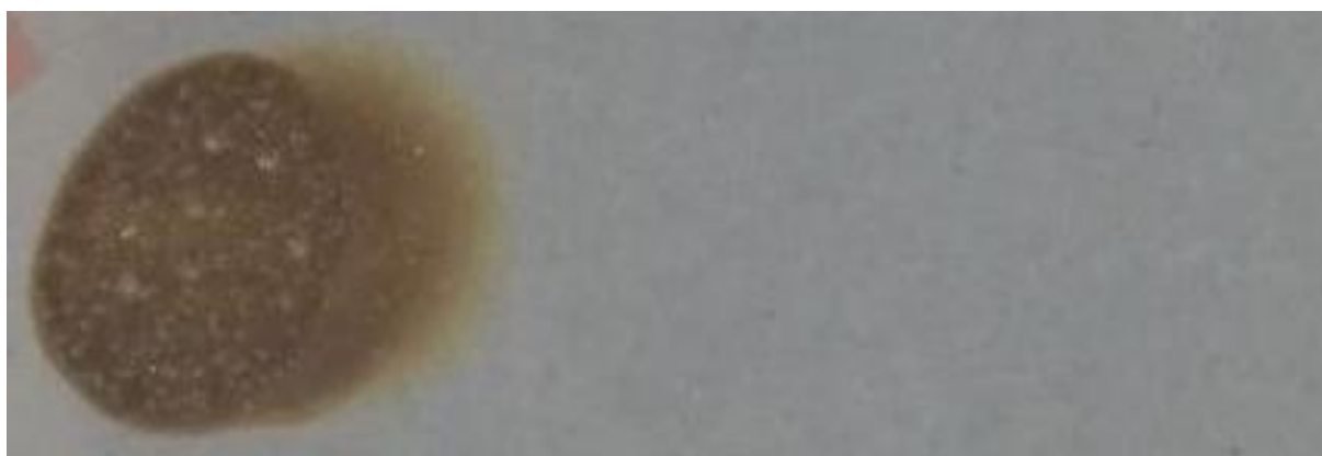
Рис. 1 Внешний вид покрытия Альфапол ПУ-2Х после воздействия 96% H 2 SO 4 в течение 3 ч.
