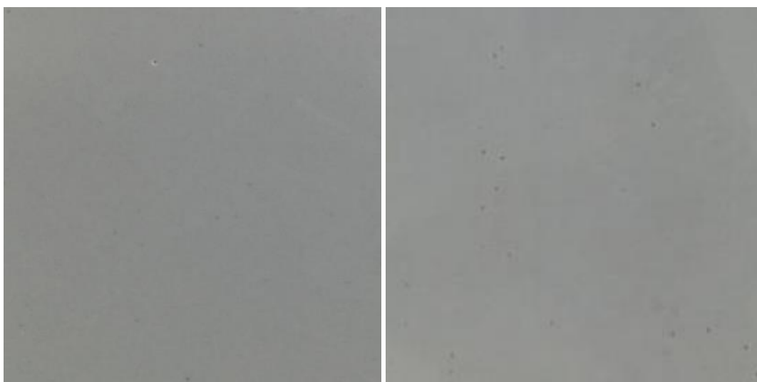
Рис. 2. Внешний вид покрытия Альфапол ПУ-2Х: а) контрольный образец, б) после воздействия 96% H 2 SO 4 в течение 24 ч.
