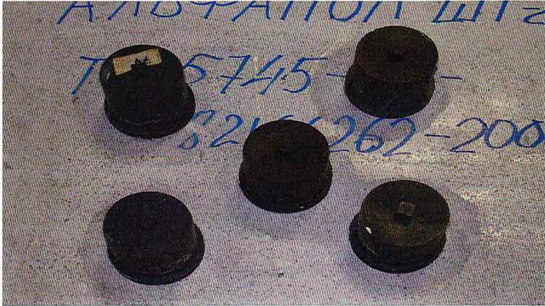
Рис. 2. Размещение измерительных камер на поверхности образцов бетона
